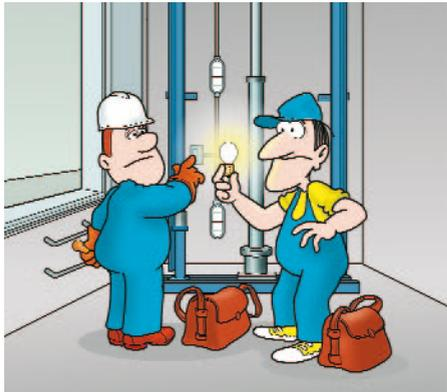
**Illuminazione vano di corsa:** il vano di corsa, quando completamente chiuso con pareti opache, deve essere provvisto di idoneo impianto di illuminazione
